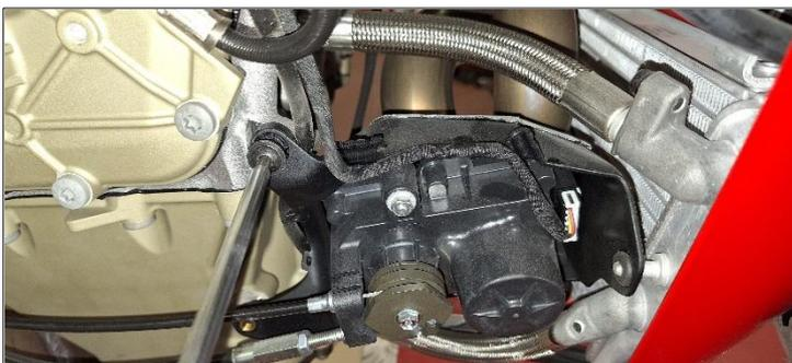
ITA Svitare le viti di fissaggio del motorino valvola
