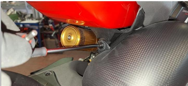
**ITA** Svitare le viti di fissaggio del paracalore collettore verticale e rimuoverlo
