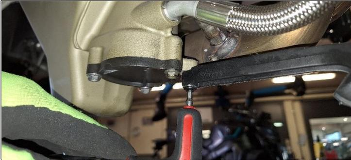
**ITA** Svitare la vite di fissaggio del supporto inferiore radiatore
