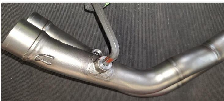
**ITA** Avvitare i tappi con le apposite guarnizioni in rame Rif 40-41 sugli attacchi sonda dei collettori
