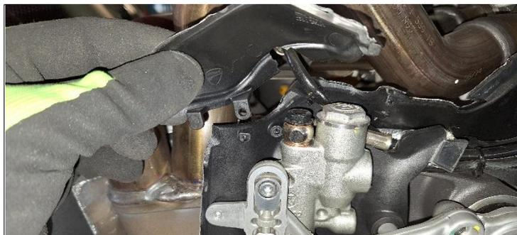
**ITA** Rimuovere plastica paracalore e scollegare i cavi sonda (3 e 4) del collettore posteriore
