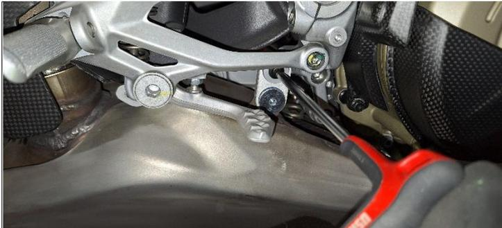
**ITA** Svitare le viti di fissaggio del silenziatore e rimuoverlo, conservando le bielle per il montaggio del kit Termignoni
