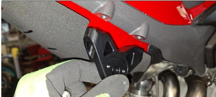
**ITA** Nel caso di montaggio senza pedane passeggero utilizzare le staffe Rif 23 e fissare al telaio con le viti Rif 35 facendo attenzione a posizionare la staffa come in foto
