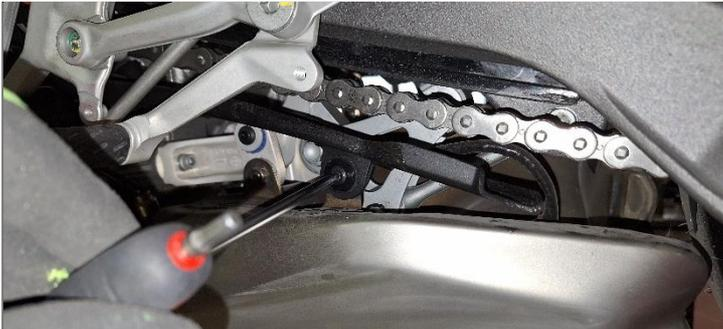
ITA Svitare la vite di fissaggio e rimuovere il pattino catena
