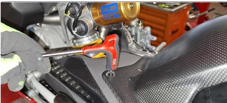
**ITA** svitare le viti di fissaggio del parafango originale e rimuoverlo
