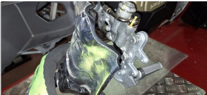
**ITA** Rimontare la plastica di protezione dal calore per il tubo freno
