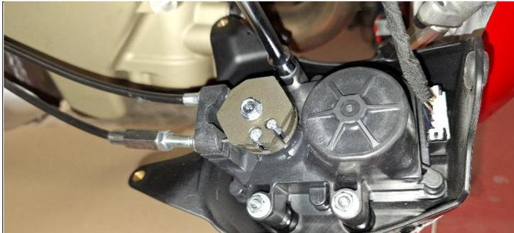
**ITA** Rimuovere il guscio di fissaggio e sganciare il connettore del motorino valvola facendo attenzione a non romperne gli incastrati
