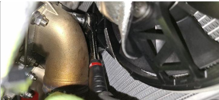
**ITA** Svitare i dadi di fissaggio collettore anteriore e rimuoverlo
