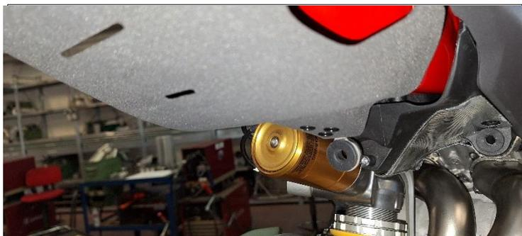
**ITA** Inserire il para serbatoio nel perno di fissaggio originale e fissare alla staffa posteriore con le viti Rif 37
