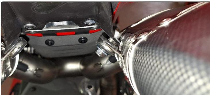
**ITA** Fissare i silenziatori alla staffa con le viti, rondelle e dadi Rif 30-43-21 in dotazione, senza serrare
