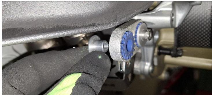
**ITA** Inserire il distanziale Rif 50 dal lato interno e fissare la staffa utilizzando la vite e rondella Rif 27-43
