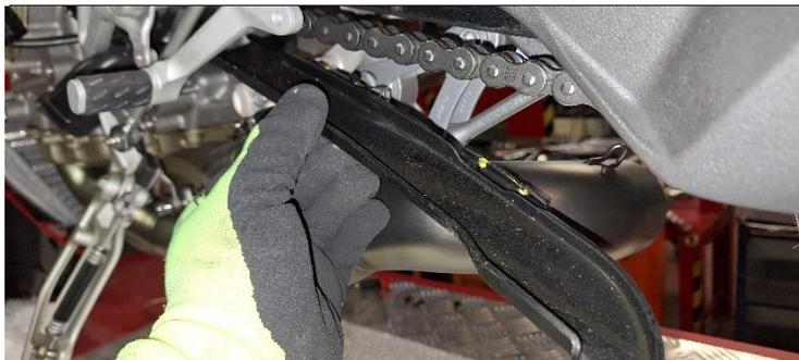
**ITA** Riposizionare il pattino catena e fissare al corpo centrale con la vite originale
