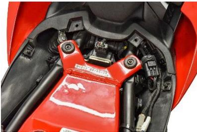
**ITA** Agganciare il cavo UpMap fornito in dotazione, nel connettore della presa di diagnosi della moto (generalmente posizionata sotto alla sella) e procedere con l'installazione seguendo le istruzioni del dispositivo
