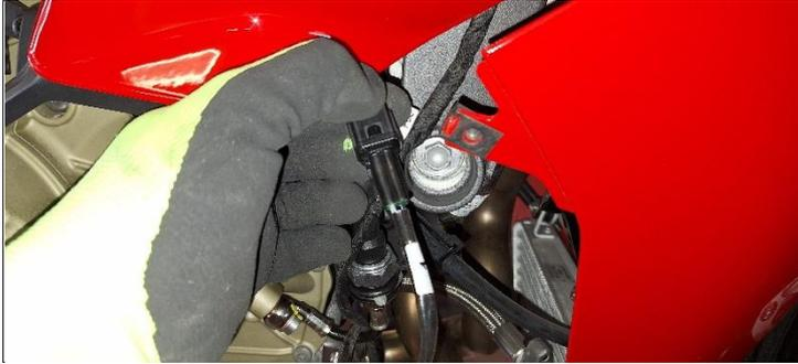
**ITA** Scollegare i connettori delle sonde lambda ( 1 e 2) del collettore anteriore
