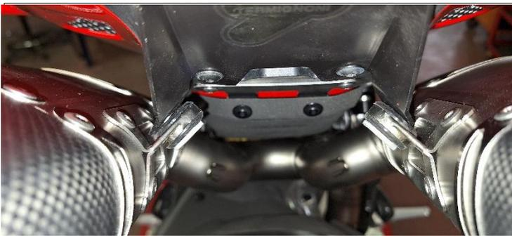
**ITA** Fare attenzione a posizionare le staffe dei silenziatori 'sotto' alla staffa di fissaggio al telaio
