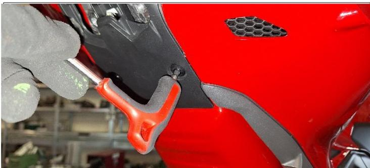
**ITA** Rimuovere le 2 viti di fissaggio della plastica nera sotto al codino
