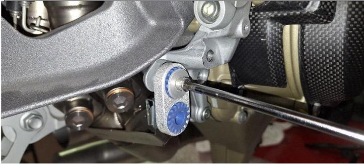
**ITA** Fissare la bielletta originale al telaio con la vite originale
