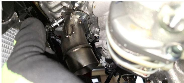
**ITA** Posizionare gli attacchi testa anteriori Rif 4 e fissare al motore utilizzando i dadi originali senza serrare
