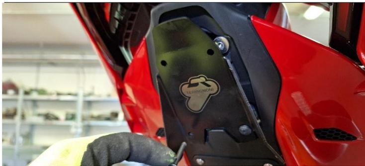
**ITA** Posizionare la staffa Rif 17 e fissare al telaio con le viti 19 - 28
