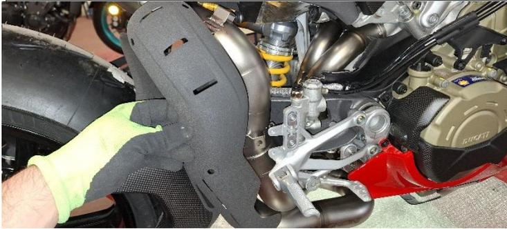
**ITA** Posizionare il paracalore in carbonio Rif 14 sul corpo finale e fissare con le viti Rif 37
